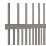
Espacement réduit par rajout de tubes dans le soubassement
