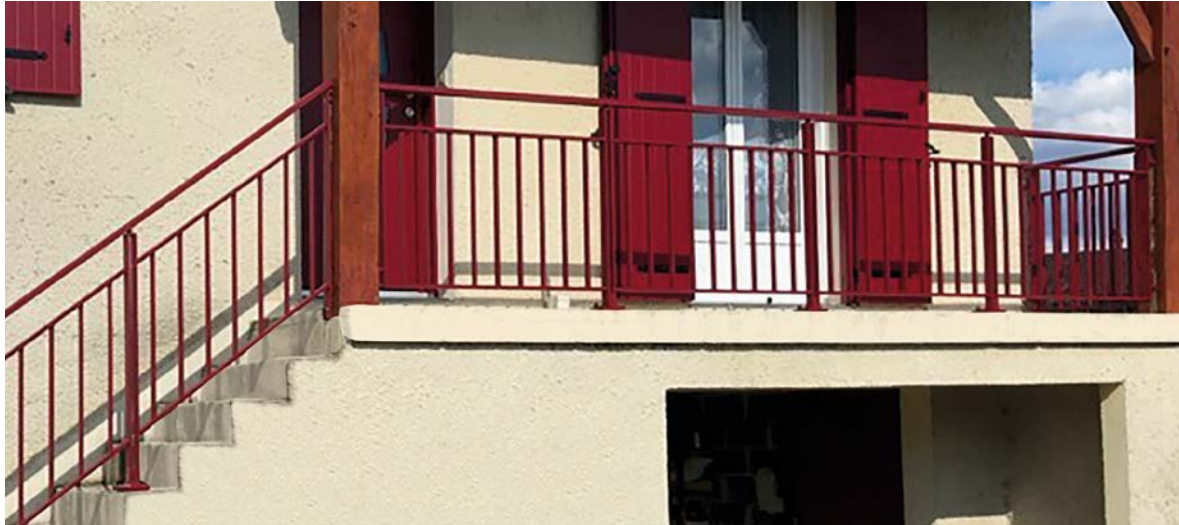
Barreaudé sous lisse intermédiaire. Pose en nez de dalle extérieur. RAL 7035.
