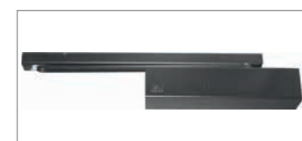
FERME PORTE À GLISSIÈRE* Freinage à l'ouverture réglable. À-coup final accéléré (7° - 0°). Fermeture entièrement contrôlée avec vitesse réglable. Retardement à la fermeture. (*Existe en 2 versions en fonction des dimensions de la porte) POIDS DE LA PORTE MAXI : 110 KG HAUTEUR MAXI : 2390 MM LARGEUR MAXI : 1350 MM
